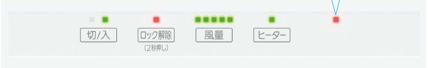
管理する方にも親切設計へ。従来は側面にあった電源・風量調節・ヒーター設定などのスイッチを本体前面に配置したほか、軽快なタッチスイッチも新採用。設定の確認も設定変更時の操作もよりらく楽になりました。
