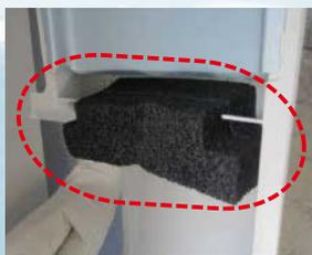
内側に粉雪侵入防止部品を取付け、粉雪が制御基板に侵入するのを阻止し、故障から守ります。
