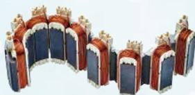
三菱独自の高効率高性能モーター。モーター鉄心を開いてからコイルを巻くことで、高密度巻線を可能にした独自技術を採用しています。
