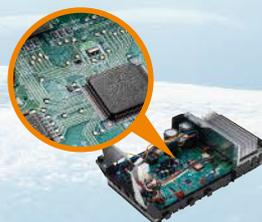
両面をポリオレフィン系樹脂でコーティング。浸水などで引き起こされる絶縁劣化による故障を抑制できます。
